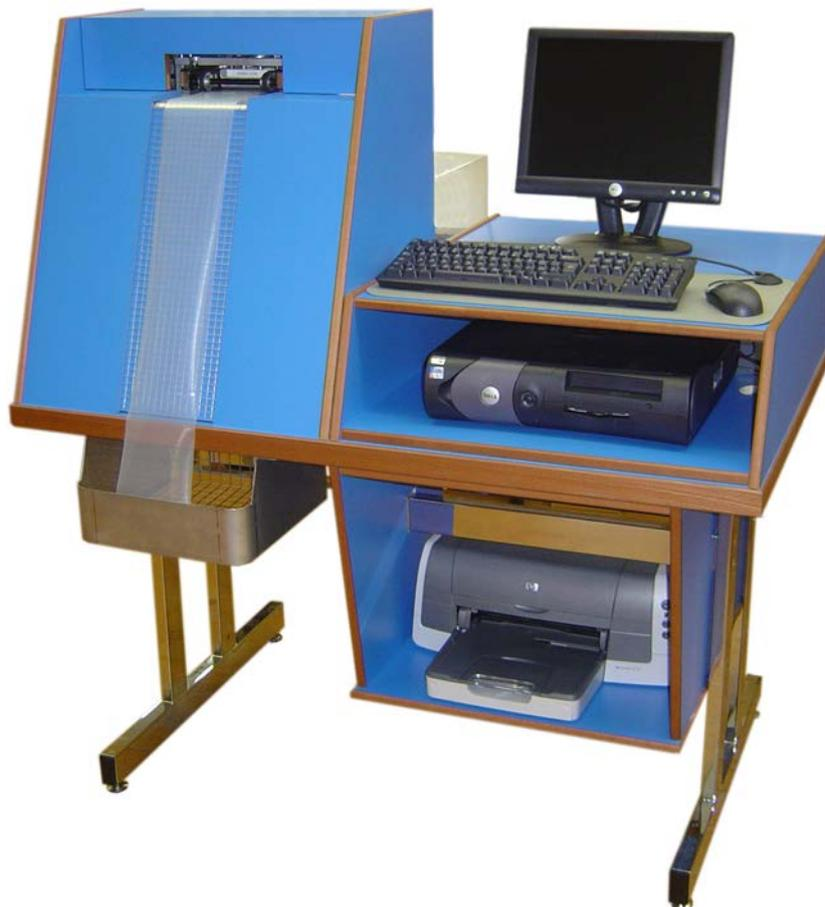
El manejo del equipo es sencillo y puede ser realizado por cualquier operario de la empresa sin necesidad de recibir una formación intensiva. El Filmtest puede ayudar a reducir bastante el trabajo en el laboratorio. Por poner un ejemplo, además del espesor, equipo calcula el peso por metro, que no necesita ser medido de nuevo.
